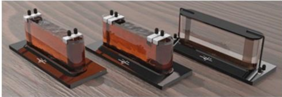
Рис. 37. 3D-модель гальванического элемента для демонстрации закона Ома для полной цепи (ванна с электролитом и электродами)
