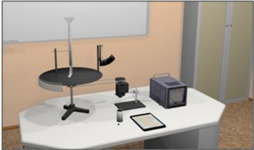
Рис. 117. Реализация механической модели опыта Штерна в графическом редакторе (Blender 3D)
