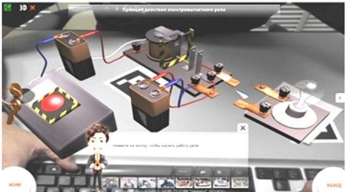
Рис. 32. Принцип действия электромагнитного реле (функция AV). Образовательный комплекс по физике «Увлекательная реальность» [100]
