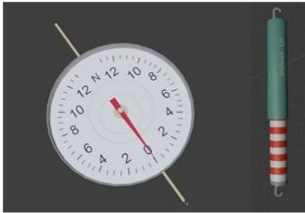
Рис.40. Фрагмент коллекции 3-D моделей учебных физических приборов: в) динамометры демонстрационные (окончание)
