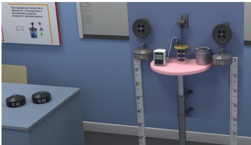
Рис. 18. Модель экспериментальной установки опыта Дж. Джоуля
